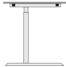
FM66 FLACHKUFE RUNDROHR stufenlose Höhenverstellung von 650 – 850 mm durch das Lösen einer Inbusschraube Gestellfarbe: Silberaluminium
